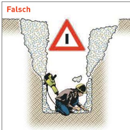
Gefahr: Künnette nicht abgesichert
